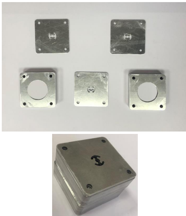
Рис. 6. Изготовленный прототип полосно-пропускающего фильтра третьего порядка.
