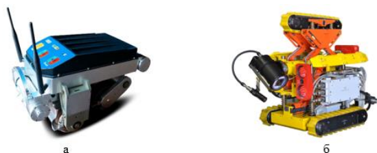
Рис. 3 а) робот для внутритрубной диагностики A2072; б) внутритрубный робот ТДК-400-М-Л
