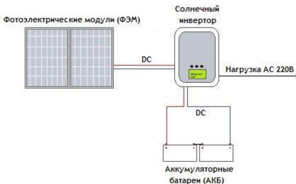
Рис. 3. Схема работы автономной системы электроснабжения
