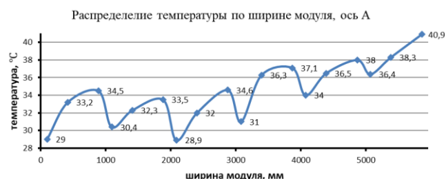
Рис. 7. Распределение температурных характеристик фотоэлектрической панели по ширине модуля
