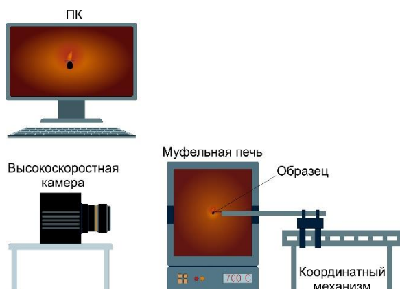
Рис.3. Принципиальная схема лабораторного стенда капельного зажигания жидких топлив.
