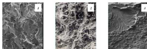
Рис. 1 Пример различных вариантов разрушения: 1 – хрупкое; 2 – вязкое; 3 – смешанное.
