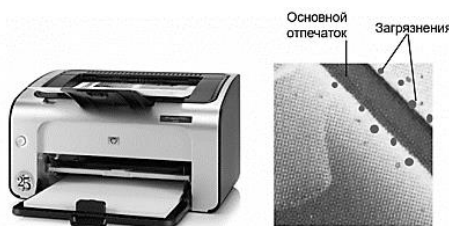
Рис.2 – Струйный принтер и дефекты печати
