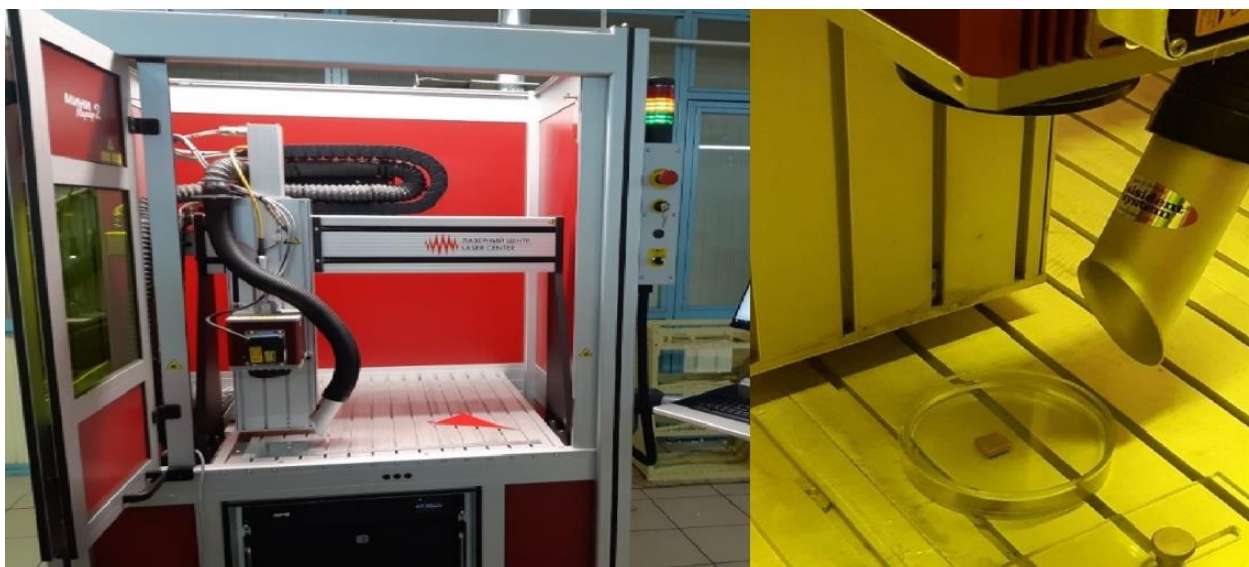
Рисунок 4.6.1 – Экспериментальной установка на основе волоконного иттербиевого лазера МиниМаркер 2-20А4 (IPG Photonics)
