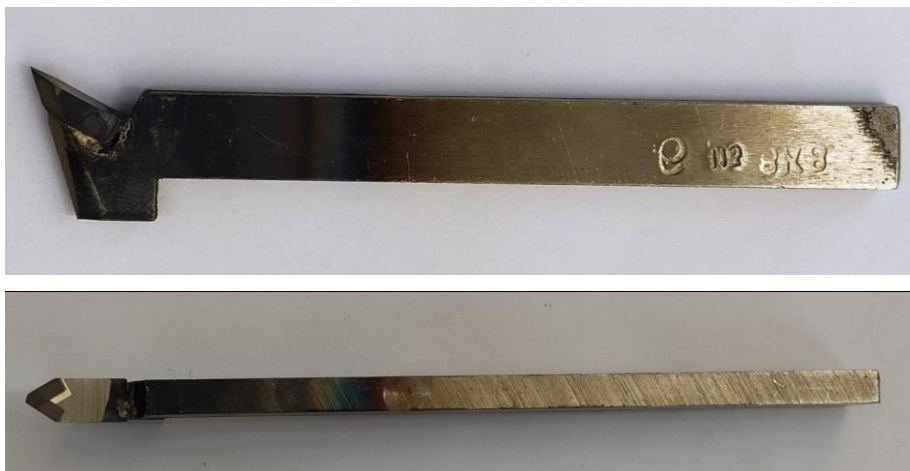
Рисунок 4.12.1 – Резец с напаянной твёрдосплавной пластиной ВК8 специальной геометрии
