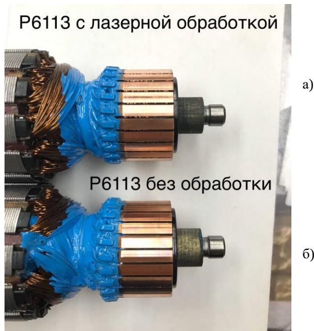
Рисунок 4.12.6 – Поверхности коллекторов роторов двигателя электроинструмента: а – обработанные модифицированным инструментом; б – обработанные стандартным инструментом
