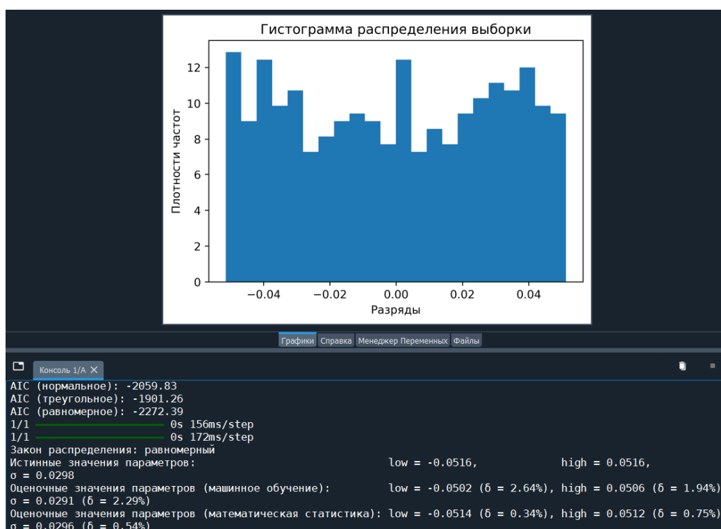
Рис. 8 – Гистограмма распределения выборки (500 значений, распределение равномерное) и результат работы модели
