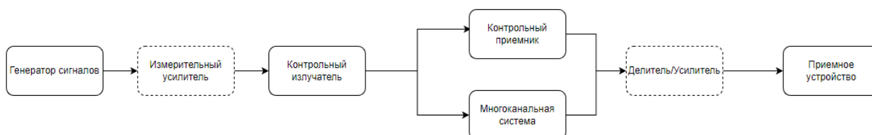
Рис.3 – Общая схема проведения контроля качества преобразователей
