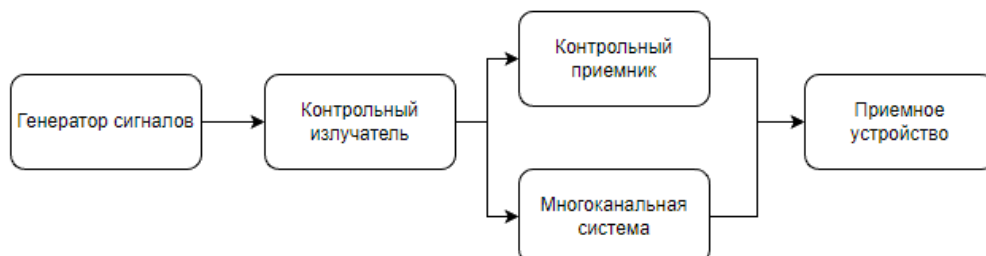
Рис. 2 – Схема измерений с излучателем и приемником
