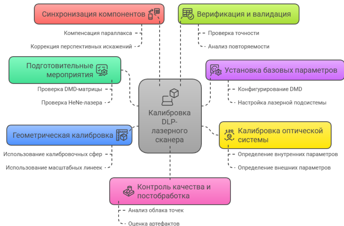
Рис.3 – Калибровка работы DLP-лазерного сканера
