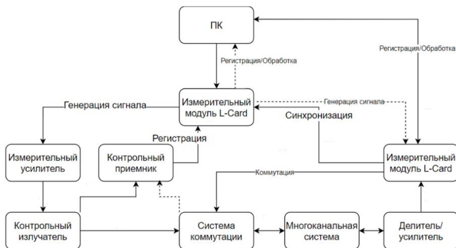
Рис.6 – Обобщенная модель автоматизации процесса контроля качества
