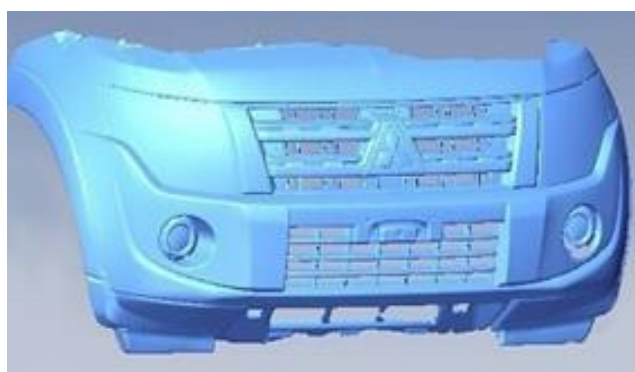
Рис.4. – Полученная 3D-модель части автомобиля и характеристики качества облака точек сканирования
