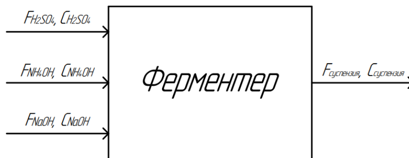
Рис.2 – Входные и выходные потоки ферментера
