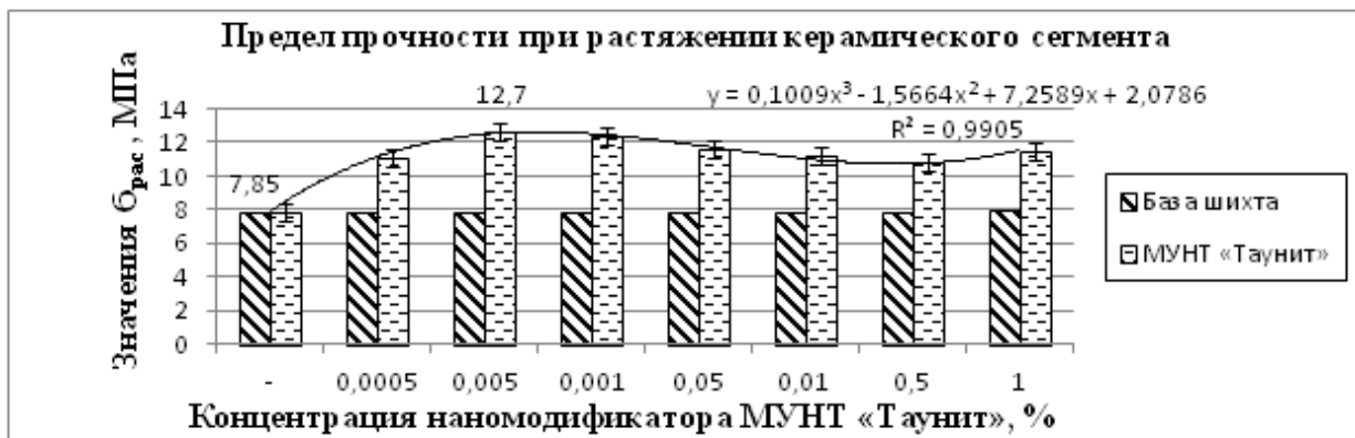
Рисунок 3 - Распределение прочности при растяжении керамического сегмента в зависимости от концентрации наномодификатора МУНТ «Таунит», %
