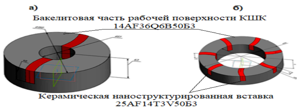
Рисунок 7 - Геометрические модели композиционных шлифовальных кругов используемых на мобильных рельсошлифовальных установках: а - для ручного станка; б - для рельсошлифовального поезда
