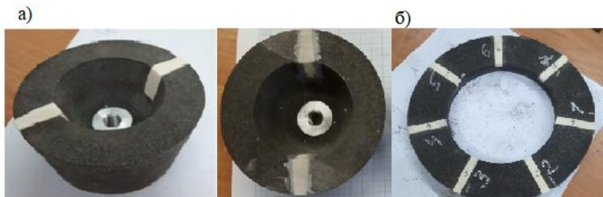
Рисунок 8 - Экспериментальные образцы композиционных шлифовальных кругов а - для ручного станка; б - для рельсошлифовального поезда
