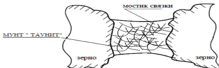
Рисунок 5 - Модель мостика связки модифицированного АИ
