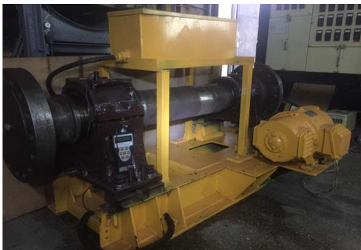
Рисунок 7 – Общий вид экспериментального стенда оценки надежности подсистем пропульсивного комплекса
