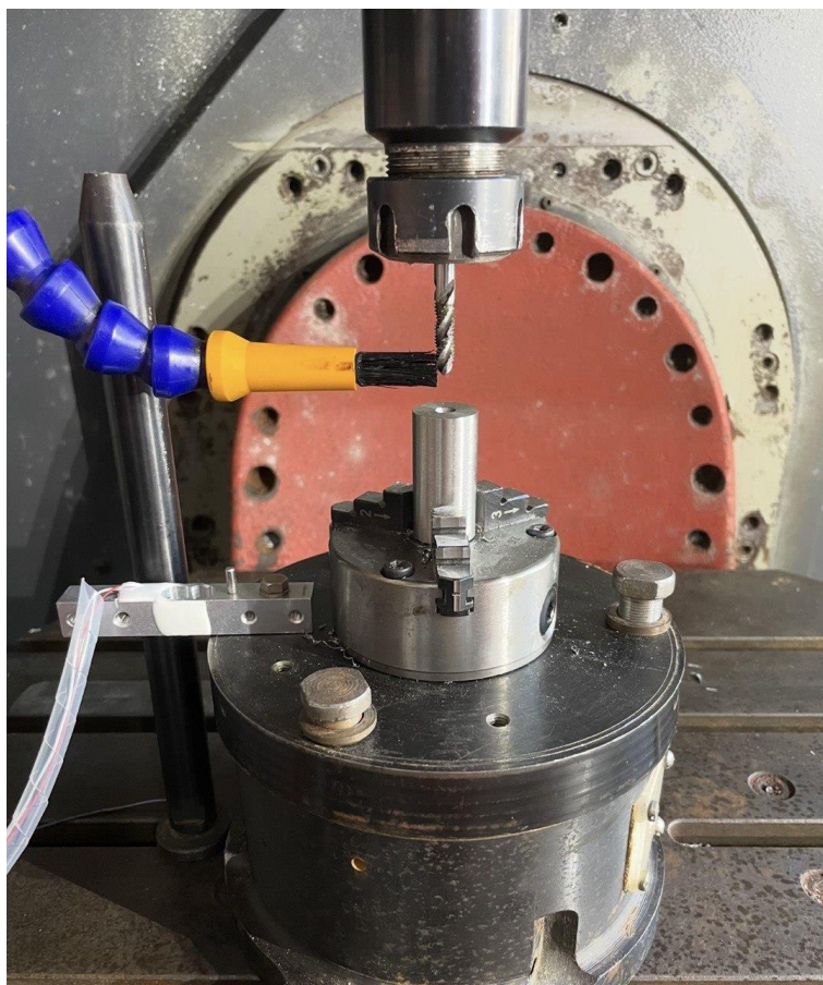
Рисунок 3.3.5 – Общий вид рабочей зоны экспериментальной установки на станке мод. MAXXmill 630 в процессе проведения исследований при реализации разработанного способа
