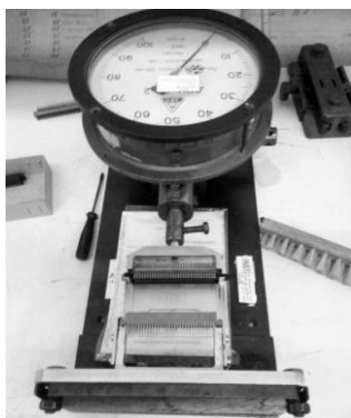
Рис.1 – Внешний вид установки для измерения суммарной силы сочленения-расчленения электрических соединителей
