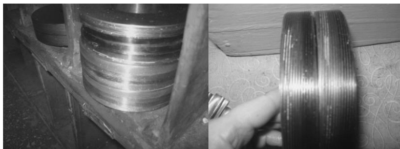
Рис.1 – Резьбонакатные ролики со следами повреждений и разрушений рабочих поверхностей в процессе эксплуатации
