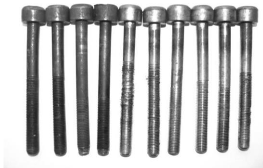
Рис.2 – Наиболее характерные примеры различных видов брака наружной резьбы, вызванных взаимосвязанными отказами в процессе резьбонакатывания
