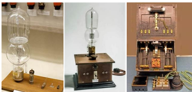
Рис. 11. Телефонный усилитель Telefunken EV72: принципиальная схема, общий вид лампы LRS Relay на фоне современных радиоламп, общий вид усилителя (1913 г.) и монтаж усилителя.
