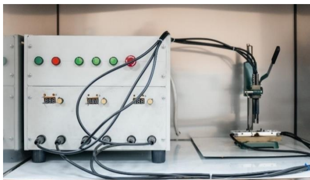
Рис. 2. Внешний вид передней панели и реакционной зоны трехфазного дугового реактора
