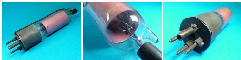
Рис.2. Триод типа M Schott Jena. 1920 г.
