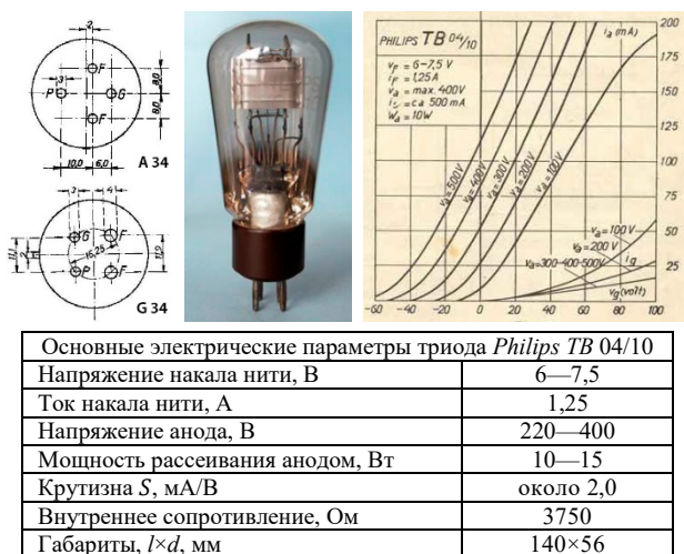
Рис. 11. Триод Philips TB 04/10 : общий вид, варианты цоколей, анодные и анодно-сеточные характеристики и основные электрические параметры.
