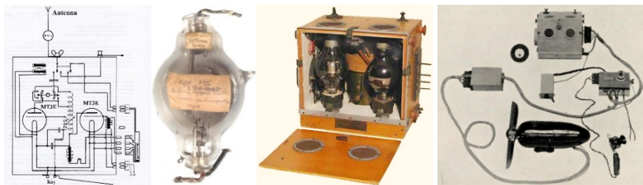
Рис. 4. Принципиальная схема передатчика Marconi типа AD1 (1921 г.) и общий вид триода Marconi MT3E (1920 г.). Общий вид самолетного телефонного радиопередатчика типа AD1 (1920 г.). Пульт управления радиопередатчика типа AD1 , к которому подключены: микрофон, передатчик, динамо-машина, блок телеграфного ключа и кабель радиоприемника (1920 г.).
