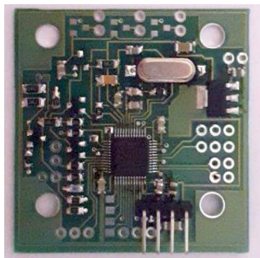
Рис.2 – Внешний вид разработанного модуля обработки изображения
