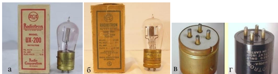
Рис. 1. Радиолампы RCA Radiotron «мягкого типа»: а — детекторная лампа триод GE UV200 с наполнением аргоном, б — усилительная лампа триод Westinghouse UV201 без наполнения газом (справа). 1920 г. Варианты цоколей: в — латунное основание UV с керамической изолирующей вставкой и короткими штифтами (1921—1924), г — бакелитовое короткое основание UV (1924—1925).
