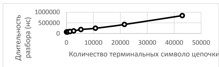
Рис.2 - Зависимость среднего времени синтаксического разбора от длины входной цепочки
