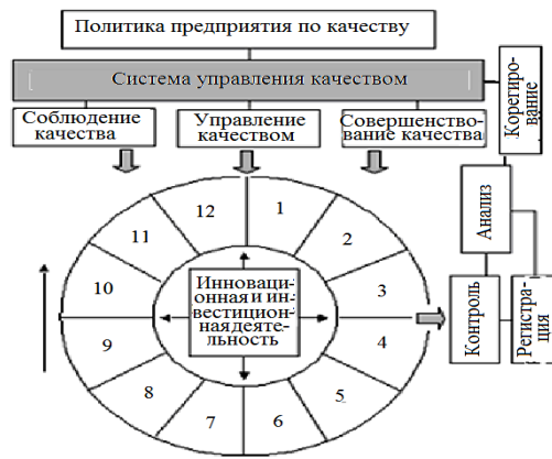
Рис.1 – Схема влияния управления качеством на элементы цикла жизни прибора: 1 - маркетинг и изучение рынка; 2 - проектирование и разработка конструкции прибора; 3 – разработка технологических процессов изготовления; 4 – закупка необходимого; 5 – производство прибора; 6 – его проверка; 7 - упаковка и складирование; 8 – сбыт и продажа; 9 – монтаж, сдача в эксплуатацию; 10 – техническая помощь, обслуживание; 11 – эксплуатация; 12 – утилизация
