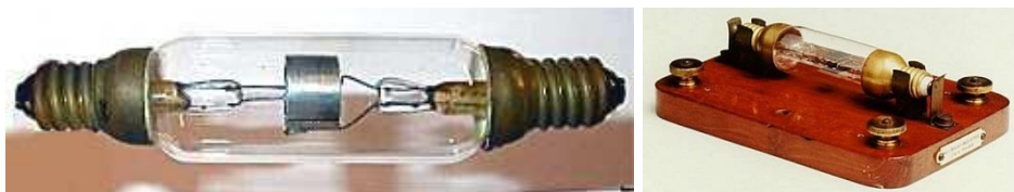
Рис. 6. Первая голландская радиолампа (триод) производства компании Metaal draadlampenfabriek Holland te Utrecht . 1918 г.
