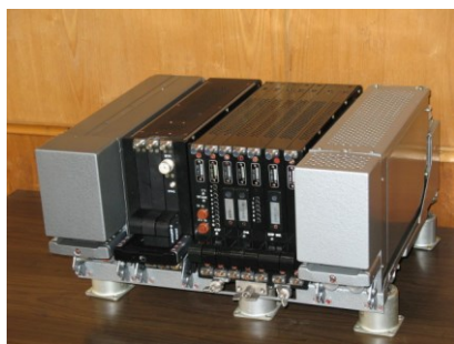
Рис. 11. Бортовой навигационно-посадочный комплекс А-331-06М с международным диапазоном частот для Су-34.
