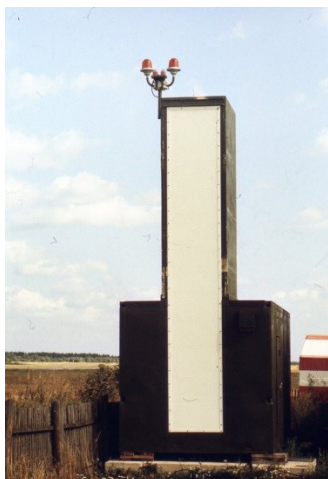
Рис. 10. Угломестный маяк 6-см диапазона «Плацдарм».
