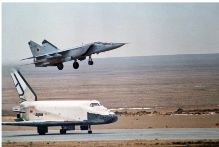
Рис. 8. Посадка «Бурана» с помощью 2-см микроволновой системы посадки «Вымпел-Б» в автоматическом режиме. 15 ноября 1988 г.
