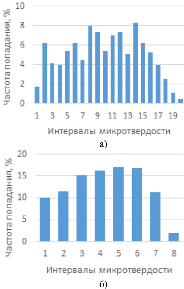
Рис. 3. Гистограммы и диаграммы распределения микротвердости образца 52%Ti+22%Al+26%Nb, количество интервалов: а) m=20 , б) m=8
