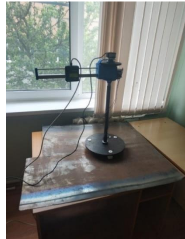
Рис. 4. Подготовка профилографа на листе металла для экспериментального исследования
