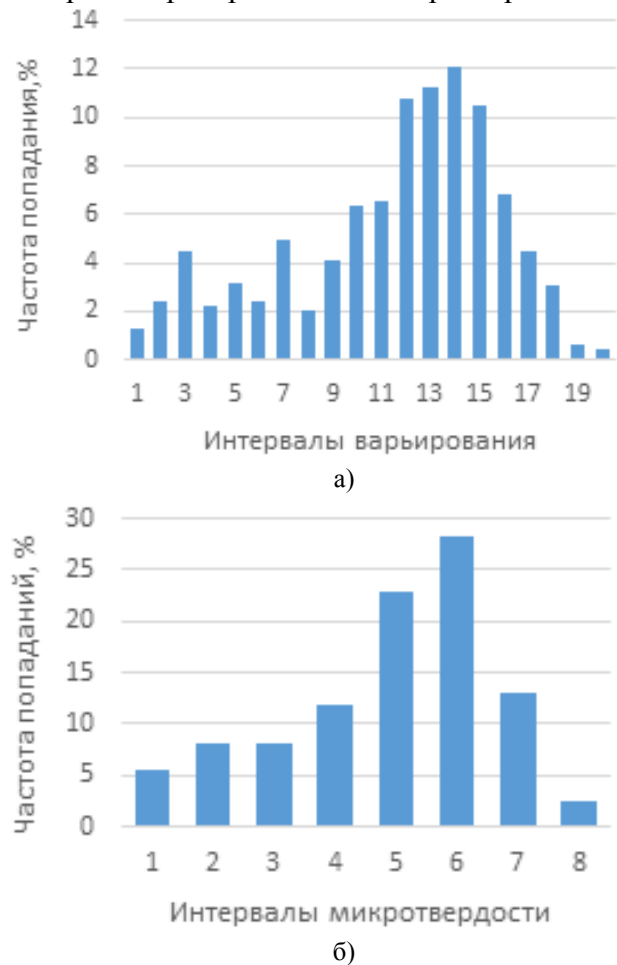
Рис. 2. Гистограммы и диаграммы распределения микротвердости образца 50%Ti+25%Al+25%Nb, количество интервалов: а) m=20 , б) m=8
