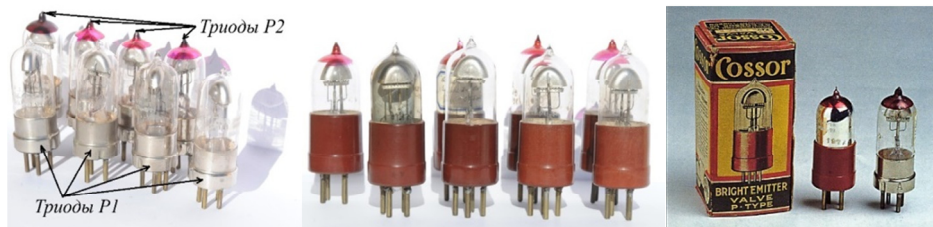
Рис. 11. Общий вид триодов Cossor P1 и P2 Bright Emitter с металлическими и бакелитовыми цоколями. Общий упаковочной коробки P1 и P2 (1922—1925 гг.). Цветная метка в верхней части баллона Cossor P2 указывала на ее отличие от Cossor P1 . Fig. 11. General view of Cossor P1 and P2 Bright Emitter triodes with metal and bakelite bases. General view of the P1 and P2 packaging box (1922-1925). A colored mark on the top of the Cossor P2's cylinder indicated its difference from the Cossor P1
