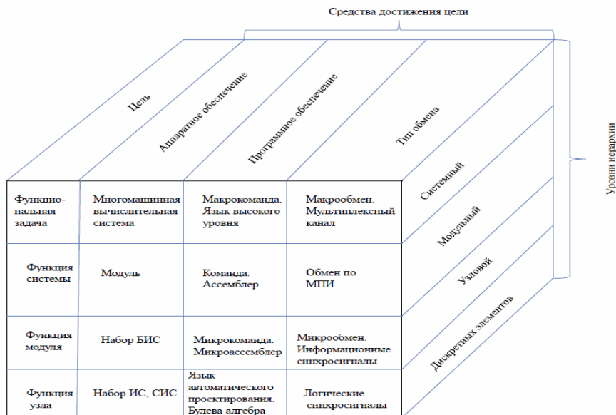
Рис. 2. Концептуальная модель магистрально-модульной измерительно-вычислительной подсистемы.
