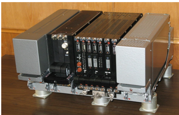
Рис. 15. БНПК А-331-06М с международным диапазоном частот.
