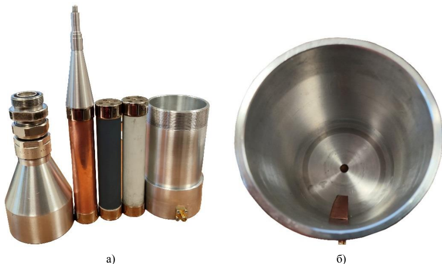
Рис. 3. а) корпус нагрузки и высоковольтные резисторы с сопротивлением 0,42 мОм, 4,7 Ом и 49,3 Ом; б) измерительная петля.
