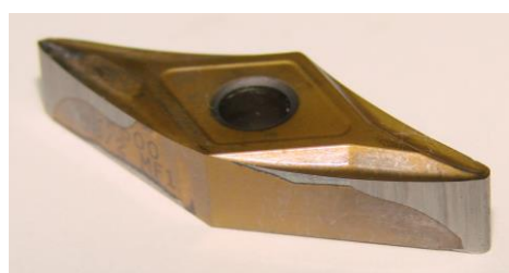
Рис. 10 Затачивание задней поверхности твердосплавной пластины с сохранением элементов ее передней поверхности и образованием отрицательной фаски
