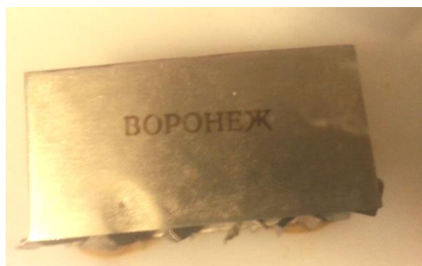
Рис. 2. Вид поверхности детали с нанесенными информационными знаками (покрытие удалено)
