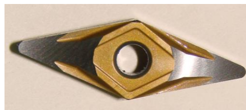
Рис. 3. Затачивание передней поверхности твердосплавной пластины с сохранением переднего угла
