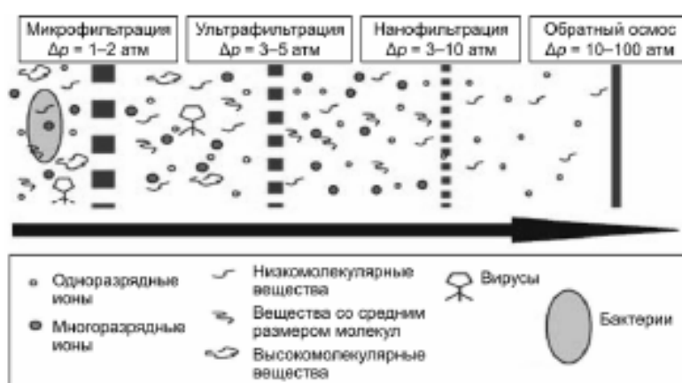
Рис.1 – Параметры мембранных методов по давлению и возможности задержания различных ингредиентов загрязнений жидкости
