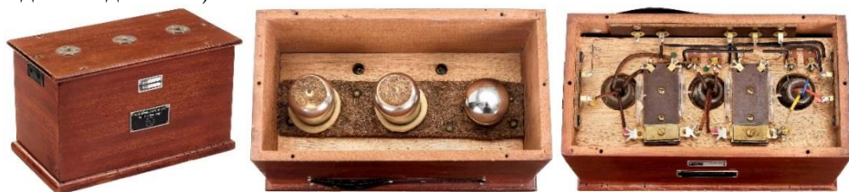
Рис. 12. Общий вид и устройство лампового усилителя типа NF333 . 1925 г.
