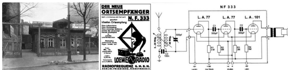
Рис. 13. Здание, в котором размещалась компания Radiofrequenz GmbH в Берлине (1923 г.). Реклама усилителя типа NF333 и его принципиальная схема. 1925 г.
