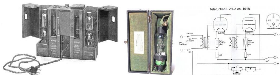
Рис. 3. Общий вид радиоприемника с двух каскадным усилителем звуковой частоты типа EV89 производства 1914 г. Лампа EVN94 в футляре (1914 г.).
