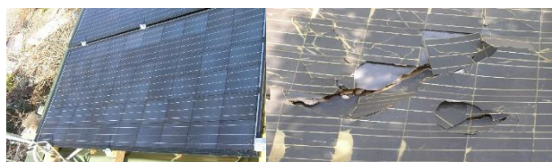
Рис. 7. Нормальная и деградировавшая панель солнечной станции в городе Алушта
