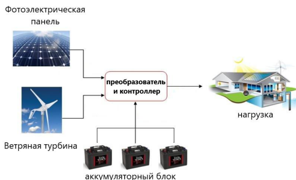
Рис. 2. Принципиальная схема ветро-солнечной системы с накопителями энергии
