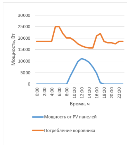
Рис. 10. График потребления и выработки электроэнергии (зимний период)
