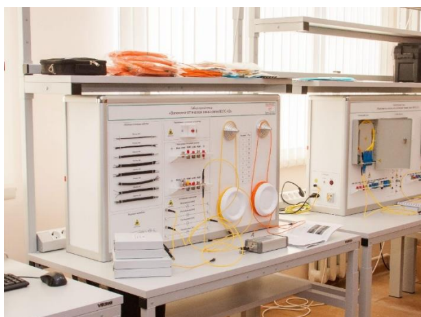
Рисунок 5.12. Стенды волоконно-оптические линии связи
