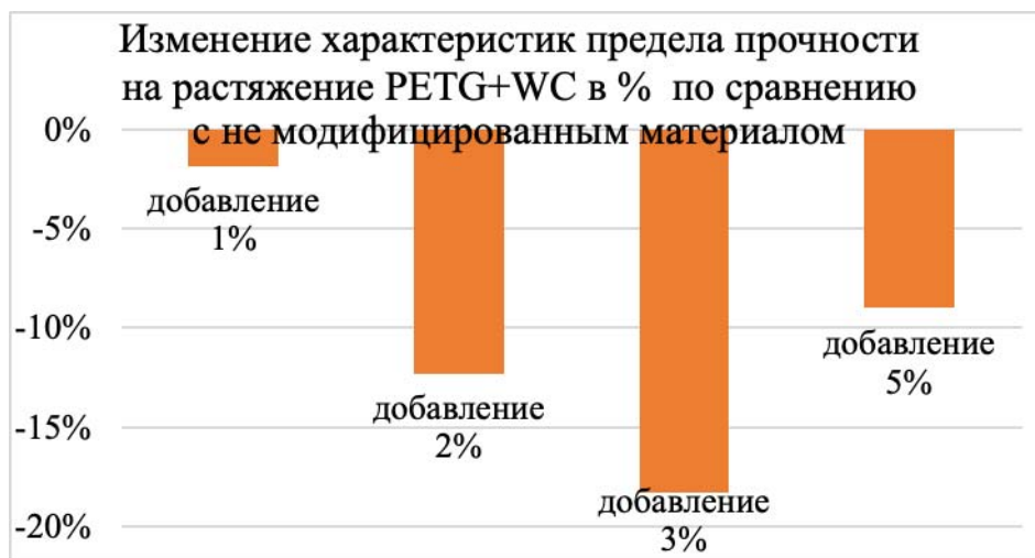
Рис. 5. Изменение характеристик PETG модифицированных наночастицами WC по сравнению с немодифицированными образцами
