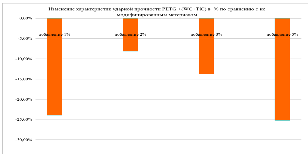
Рис. 8. Изменение характеристик ударной прочности PETG модифицированных наночастицами карбидов WC +TiC по сравнению с немодифицированным образцами
