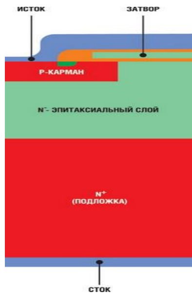
Рис. 1. Поперечный разрез кристалла классического MOSFET (вертикальный, с двойной диффузией)
