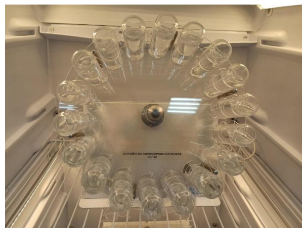
Рис. 4. Устройства для экспонирования рачков УЭР-03 [9]
