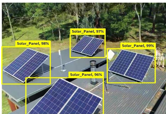
Рис. 5. Пример результатов детектирования фотоэлектрических модулей
