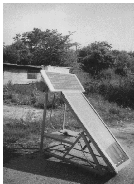
Рис. 3. Гелиоколлекторная установка с солнечной батареей.
