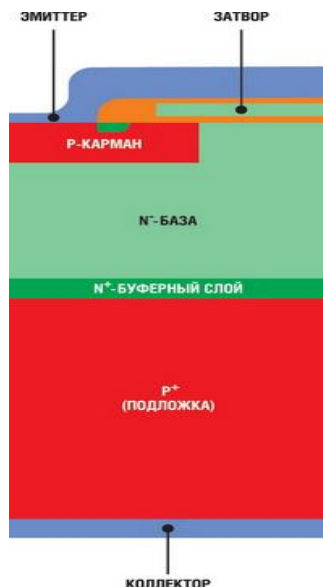
Рис. 2. Поперечный разрез кристалла биполярного транзистора с изолированным затвором (IGBT)
