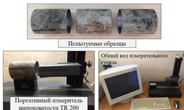
Рис.4 - Основные условия исследования шероховатости обработанной поверхности после процесса растачивания.
