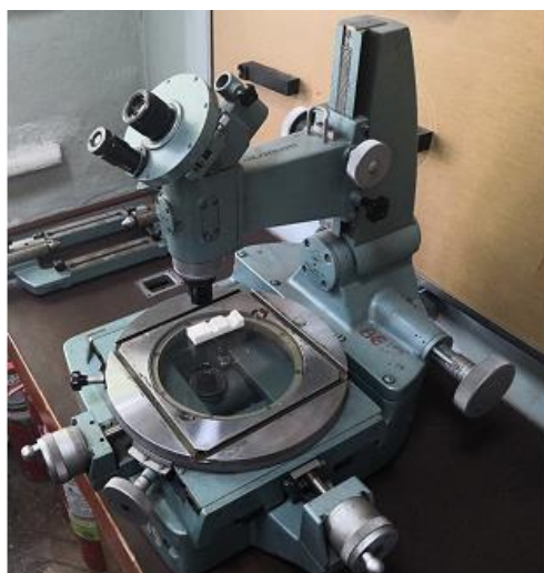
Рис. 5. Исследование профилей внутренних резьб образца под микроскопом БМИ-1
