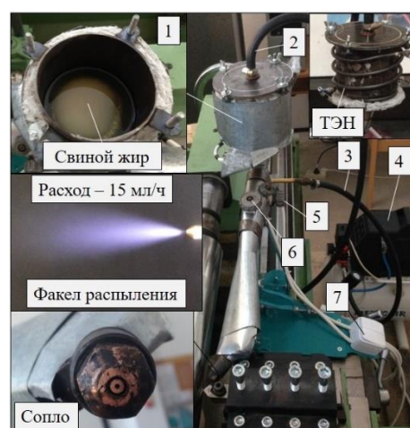
Рис.3 - Общий вид устройства для подачи смазывающих технологических сред:
