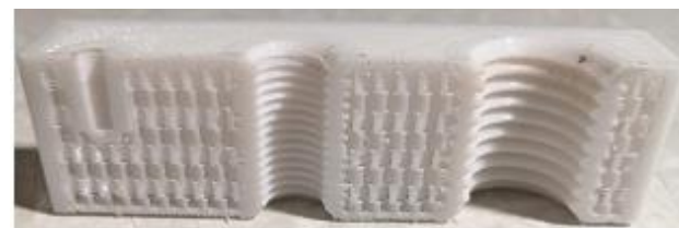
Рис. 4. Образец после удаления половины материала
