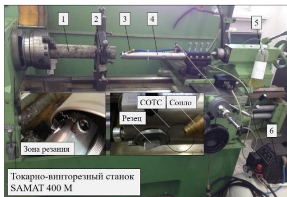
Рис.2 - Основные условия проведения экспериментальных исследований:
