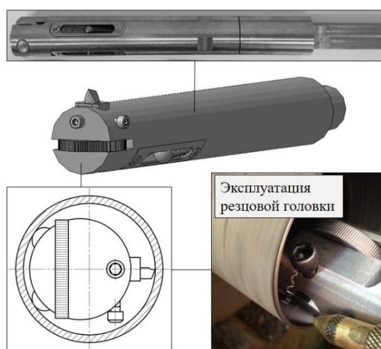
Рис.1 - Резцовая головка с возможностью радиального смещения резца
