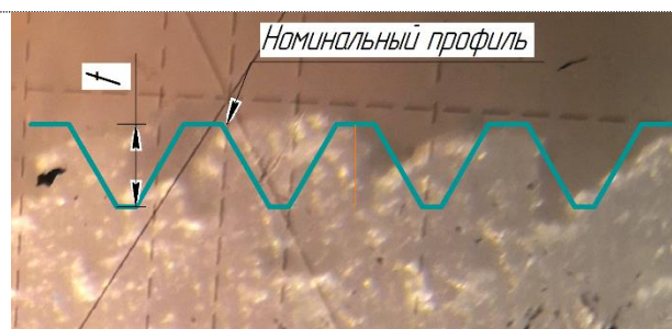
Рис. 13. Профиль резьбы М3, сформированной в образце из PETG-пластика
