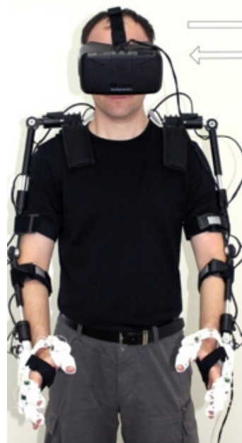
Рис.2 – Копирующий костюм для робота SAR-401
