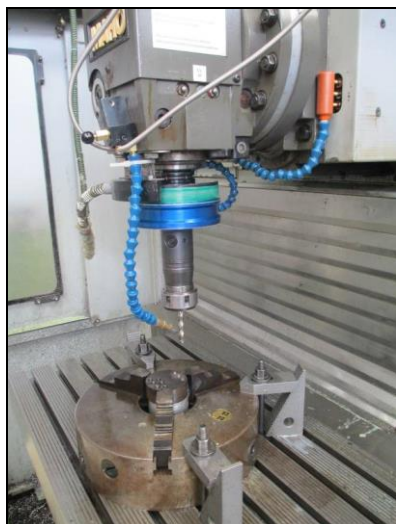
Рис. 1. Общий вид экспериментальной установки на базе станка с ЧПУ «МАНО МН 600Е»
