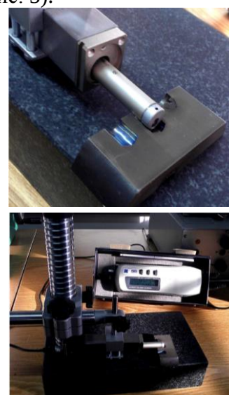
Рис. 5. Измерение шероховатости поверхностей отверстий
