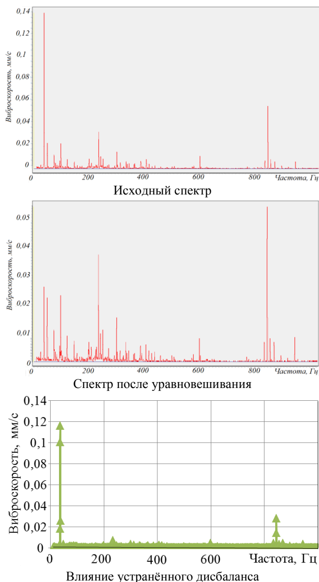
Рис. 2. Изменение спектров виброскорости в процессе уравнивания шлифовального круга
