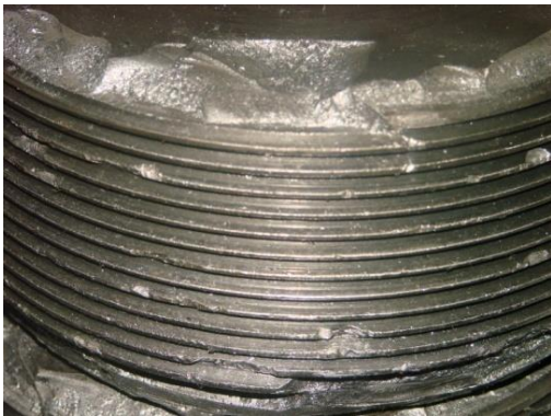
Рис. 3. Износ торцевой части резьбонакатного ролика
