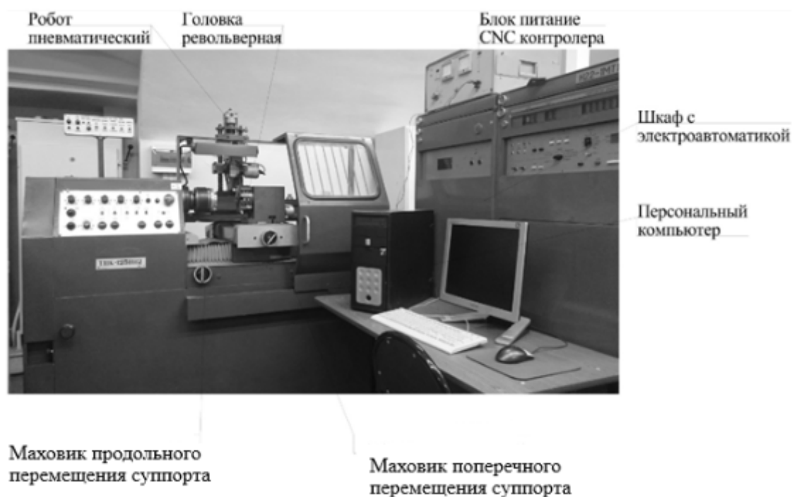
Рисунок 1. - Токарный станок ТПК125ВН2[1]
