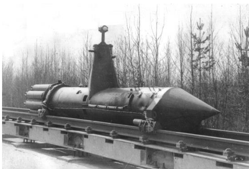
Рис. 5. Опытный образец автодинного датчика цели на заданной дальности (слева) и реактивный стенд для его полунатурных испытаний. 1980 г.
