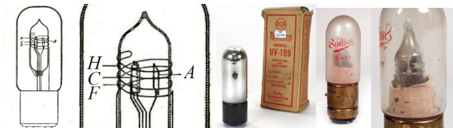
Рис. 4. Устройство лампы-детектора Sodion S-13 : A — анод, C — коллектор, F — нить накала, H — нагревательная спираль.
