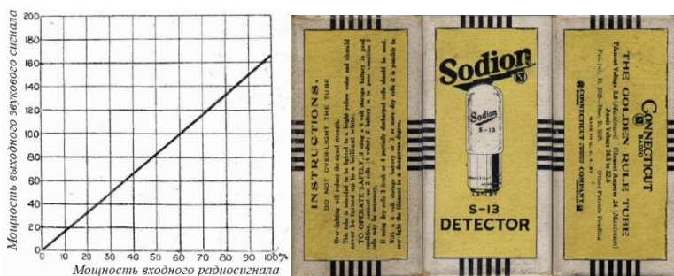
Рис. 6. Зависимость выходной звуковой мощности от мощности входного радиосигнала для детекторной лампы Sodion S-13 . Упаковка детекторной лампы Sodion S-13 .
