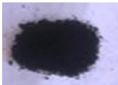
Рис. 3.6 - МУНТ «Таунит», полученный в ООО «НаноТехЦентр»
