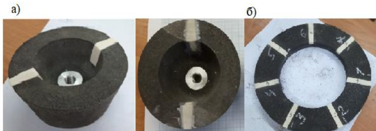
Рис. 3.15 - Экспериментальные образцы композиционных шлифовальных кругов а - для ручного станка; б - для рельсошлифовального поезда
