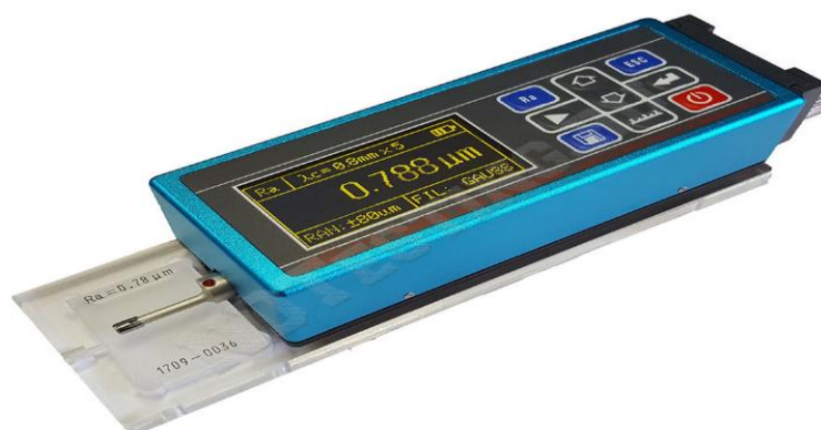
Рис 4.34 - Общий вид прибора для измерения шероховатости поверхности (ИШП-210)
