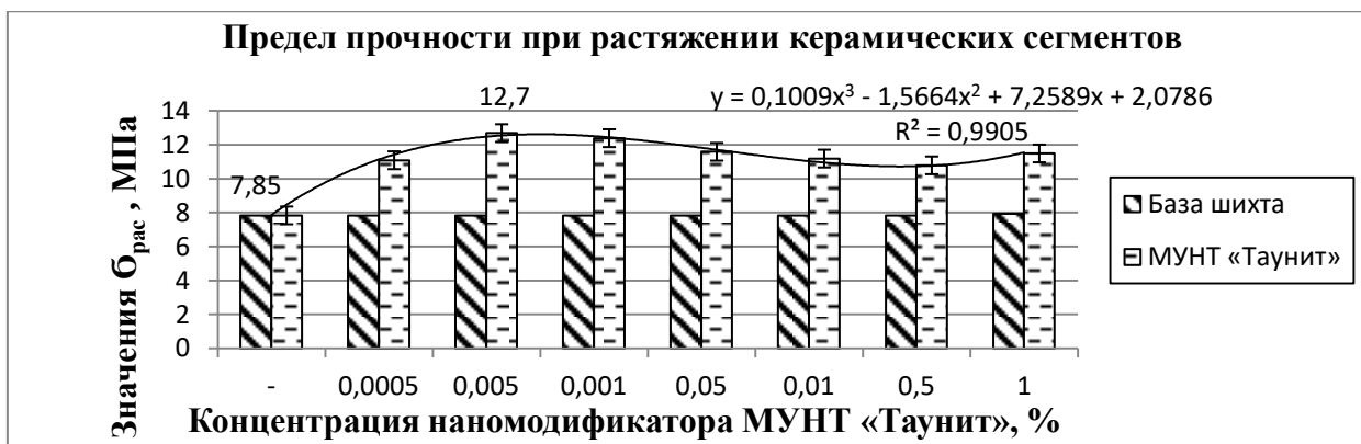
Рис. 3.11. - Распределение прочности при растяжении керамических сегментов в зависимости от концентрации наномодификатора МУНТ «Таунит», %
