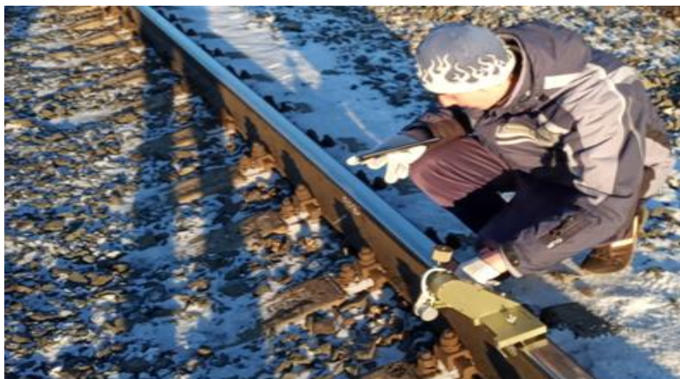
Рис. 5.2 - Контроль очертания поперечного профиля головки рельса профилографом ПР-3
