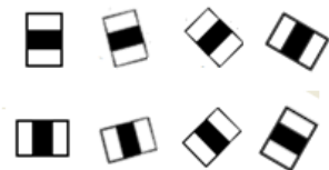
Рис. 3. Разновидности вейвлетов Хаара для детектирования тонких линий с различными углами наклона.
