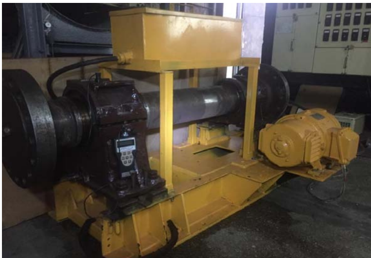
Рисунок 5.6 – Экспериментальный стенд по исследованию валопровода в радиальных подшипниках скольжения
