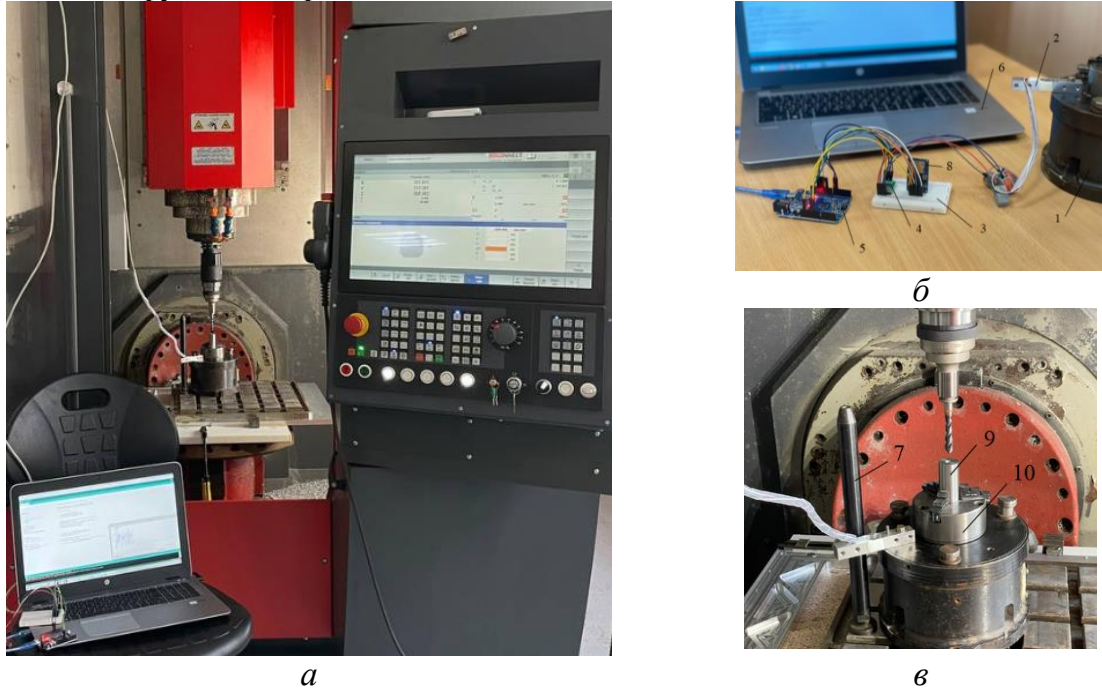
Рисунок 5 – Общие виды экспериментальной установки (а) со схемой подключения тензодатчика к ПЭВМ через Arduino UNO (б) и рабочей зоной (в)
