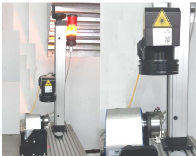
Рисунок 7 – Экспериментальная установка для лазерной абляции на базе волоконного иттербиевого лазера «FMark-100 NS»
