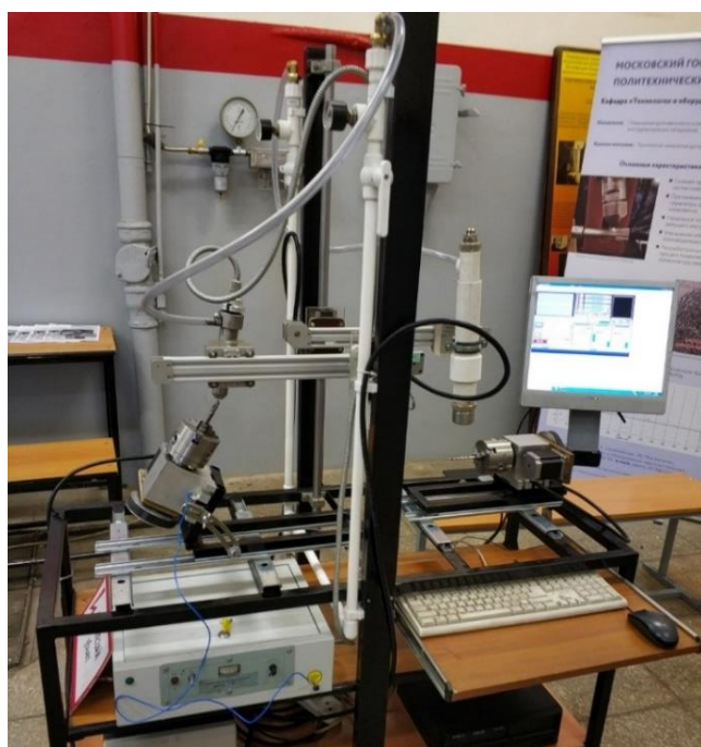
Рисунок 8 – Экспериментальная установка для нанесения дискретного диффузионного покрытия
