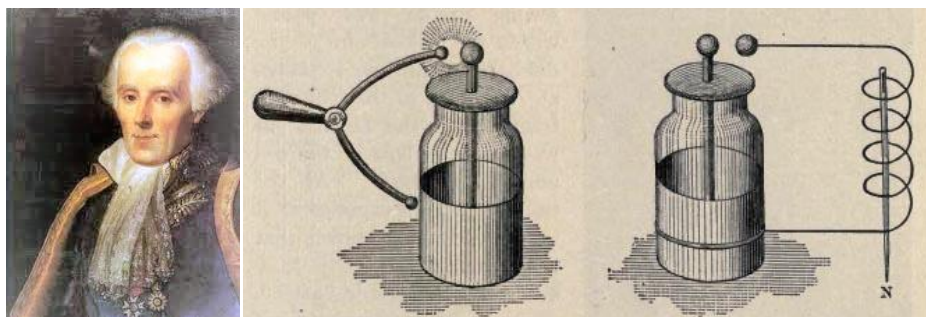
Рис. 2. Феликс Савар и его эксперимент по колебательному характеру электрического разряда лейденской банки.
