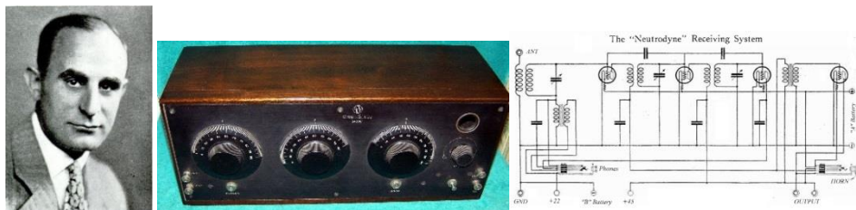
Рис. 9. Фрэнк Андреа (май 1932 г.), владелец компании F. A. D. Andrea, Inc. Общий вид нейтродинного радиоприемника Fada 160A . Принципиальная схема нейтродинного радиоприемника Fada 160A .
