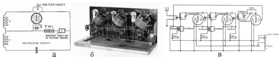
Рис. 8. Применение метода нейтрализации в ламповой схеме: а — принцип нейтрализации в ламповой схеме, б — вид монтажа нейтродина на трех ламповых триодах, в — принципиальная схема нейтродина на трех ламповых триодах.
