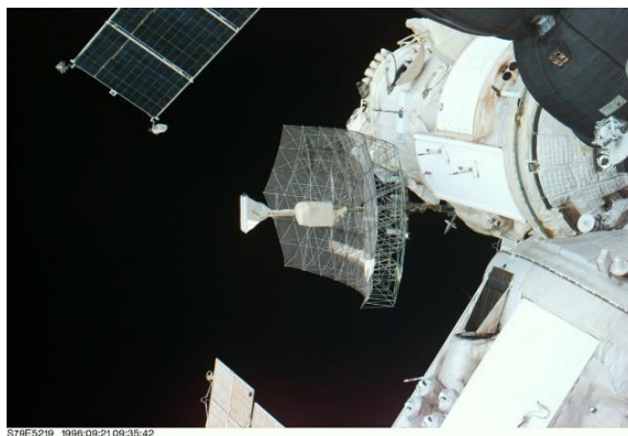
Рис. 2. Ферменный рефлектор размером 6 \times 2,7 м антенной системы ТКСА-6П на модуле «Природа» пилотируемого космического комплекса «МИР».
