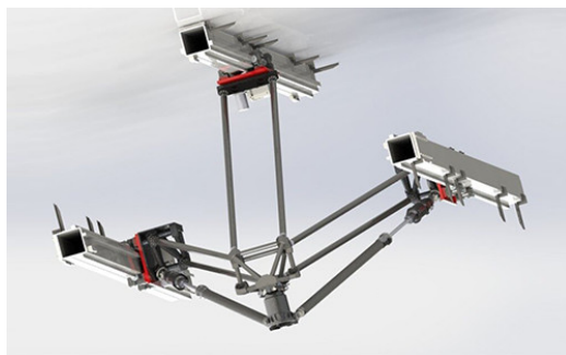
Рисунок 2. Резьбонарезной станок с МПС типа «Триаглайд» компании SigmaTau [3]
