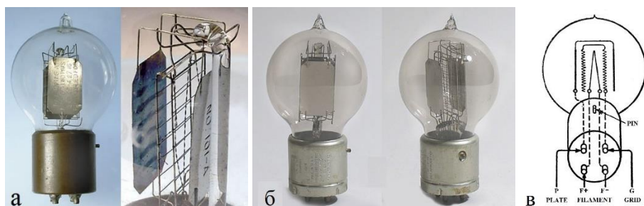
Рис. 16. Общий вид ламп типа: M — 101A (а), L — 101B (б) и их устройство (в). 1915 г.
