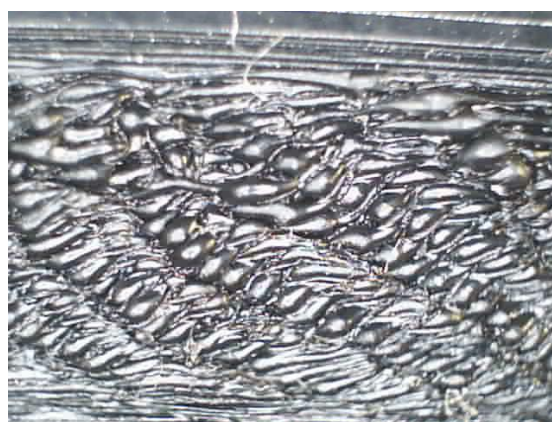
Рис. 5. Оплавление слоев детали
