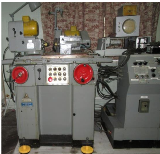
Рис. 5. Круглошлифовальный станок BUA 16 в составе экспериментального стенда, установленный на виброизолирующие опоры новой конструкции (патент UA 36389)
