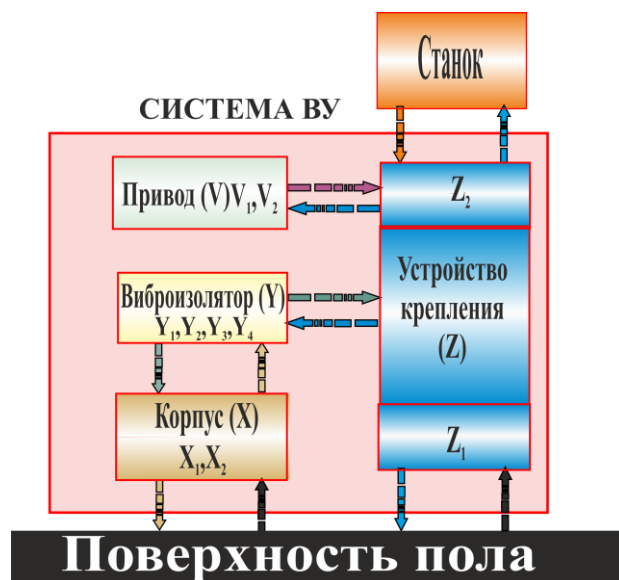
Рис. 3. Структурная схема системы виброизолирующего устройства (ВУ)
