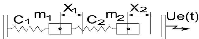
Рис.1 – Схема переносного движения с ускорением U_e(t) системы с двумя степенями свободы
