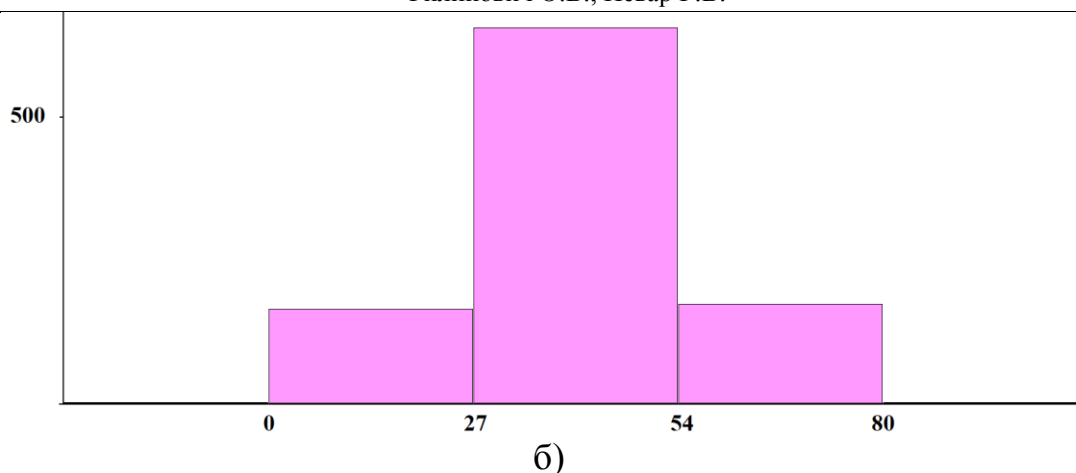
Рис.5 – Статистическое распределение значений действительных (а) и истинных (б) размеров гайки (отверстия), мкм
