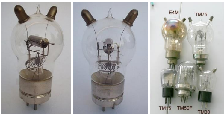
Рис. 9. Слева ламповый триод Бове типа AM10. Справа ассортимент различных типов триодов, в том числе ламп Бове.
