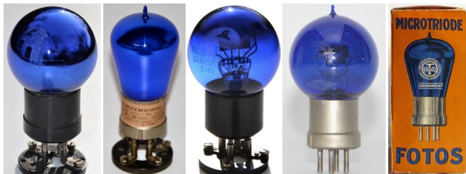
Рис. 8. Триоды FOTOS bleu , произведенные компанией Grammont в 1925 г. и 1927 г. Справа упаковка триодов FOTOS bleu .
