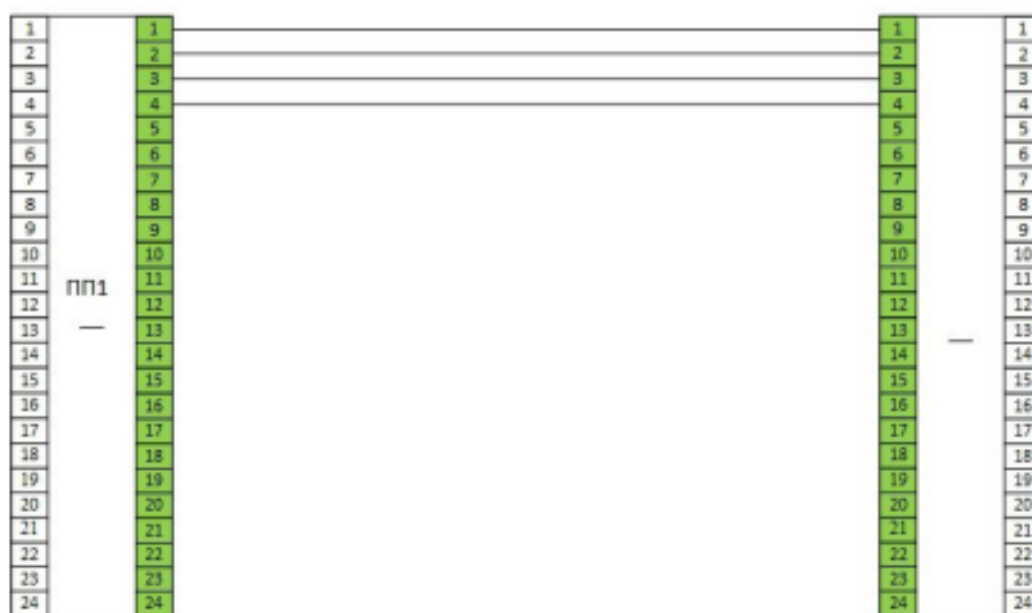
Рис. 1. Схема распределения кабелей резервной горизонтальной подсистемы
