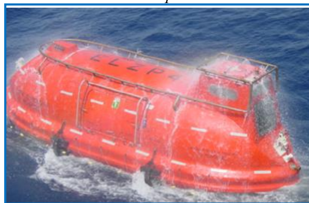
Рисунок 1.4 – Свободнопадающая шлюпка на аппарели
